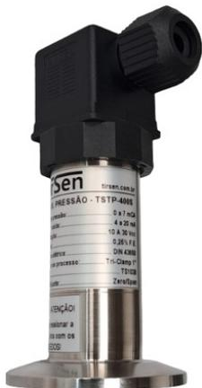
Os Transmissores TSTPS.400 têm elemento sensor piezoresistivo que converte a pressão aplicada pelo fluido em sinal elétrico. Este sinal elétrico é amplificado, linearizado e disponibilizado em sinal padronizado por uma eletrônica de alta confiabilidade construída com componentes em SMD.
